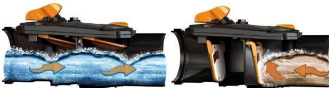
Figura 92 – Funzionamento del sistema antiriflusso
