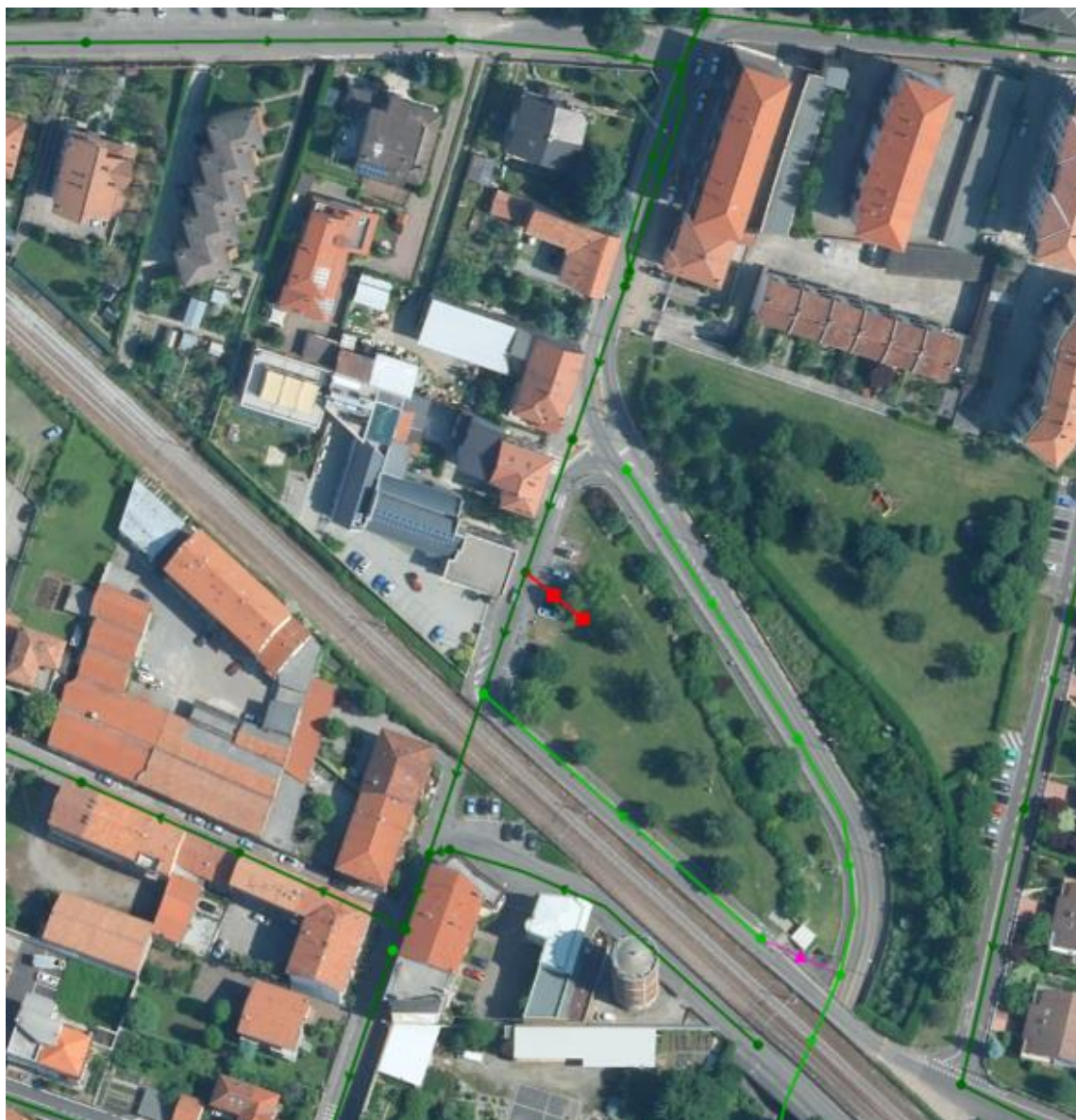
Figura 52 – Inserimento nuova vasca nell'area verde di fronte alla stazione
