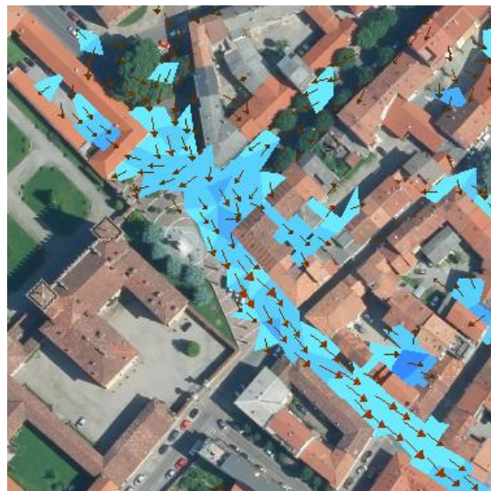
Figura 47: allagamenti a confronto: a sinistra immagine dell'allagamento reale riscontrato all'incrocio tra via IV Novembre e Piazza Castelbarco, a destra l'allagamento risultante dalla simulazione del medesimo evento
