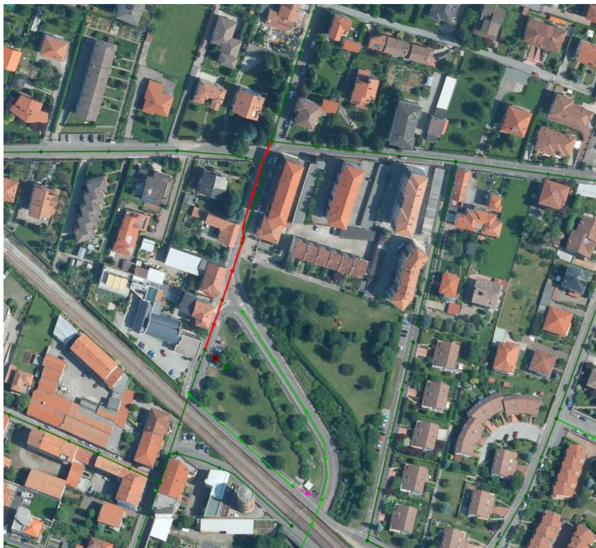
Figura 51 – Tracciato della rete fognaria in progetto lungo via Vittorio Veneto
