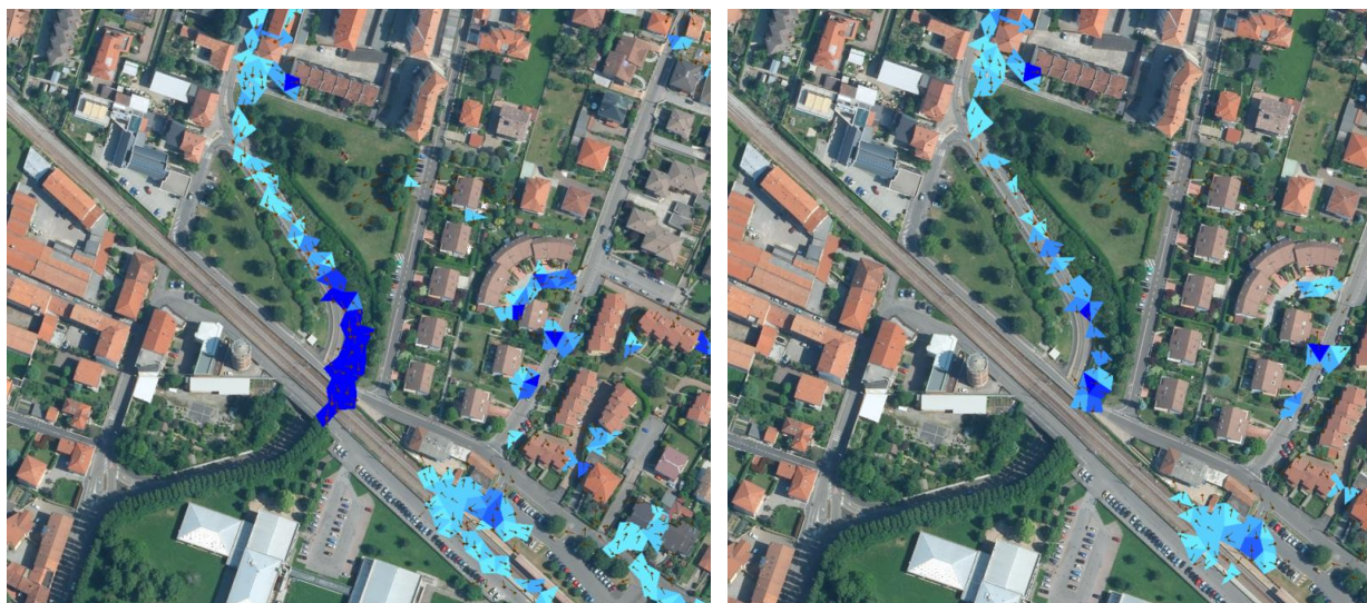
Figura 41: allagamenti a confronto: a sinistra T2 anni da modello, a destra evento del 24 luglio h.13 in corrispondenza del sottopasso di via V. Veneto
