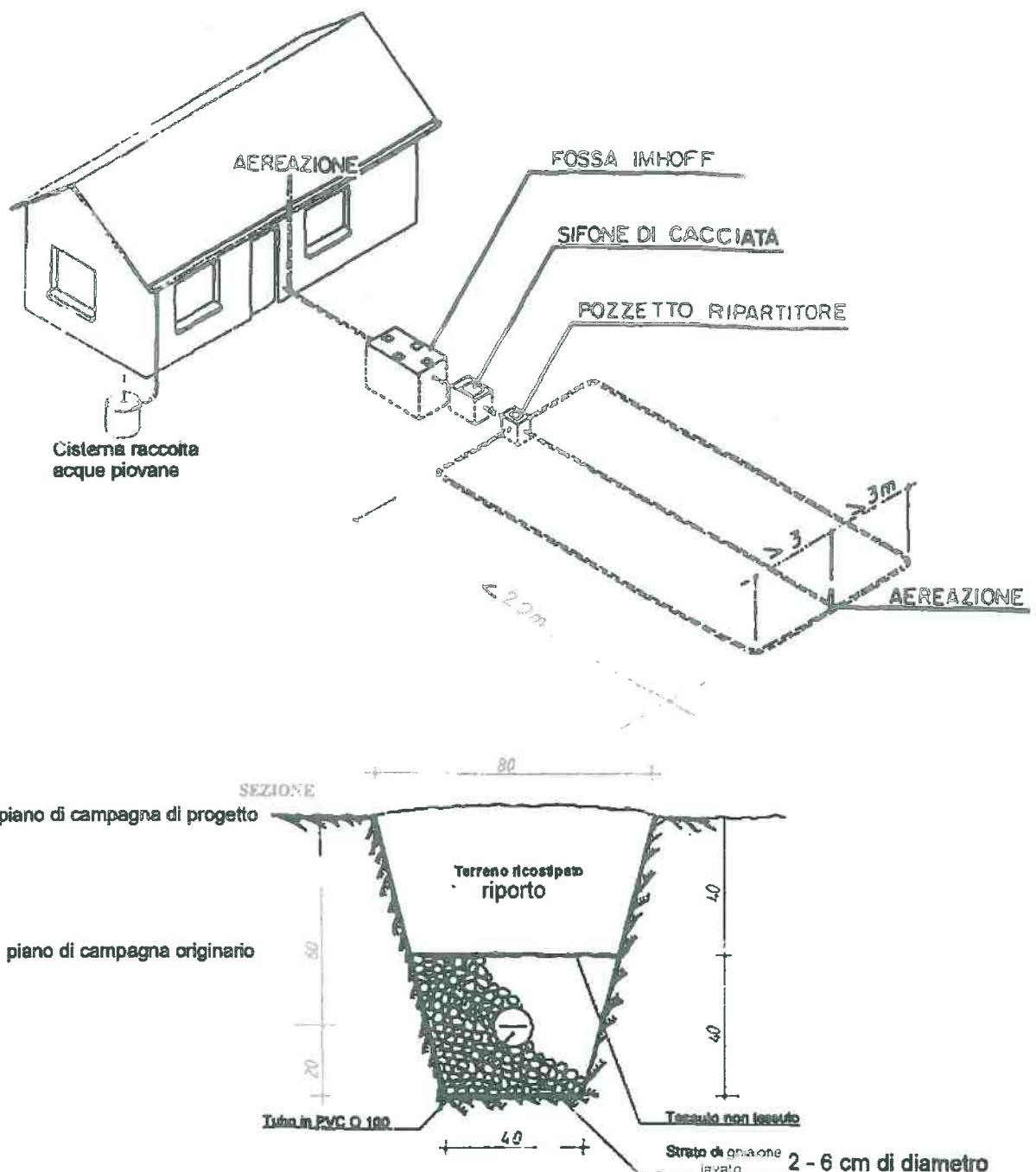
Nell'esempio sono indicate 3 linee di tubi da 20 m di lunghezza mentre per il progetto saranno sufficienti solo due tubi da 6 m di lunghezza, distanza tra loro sempre 3 m
